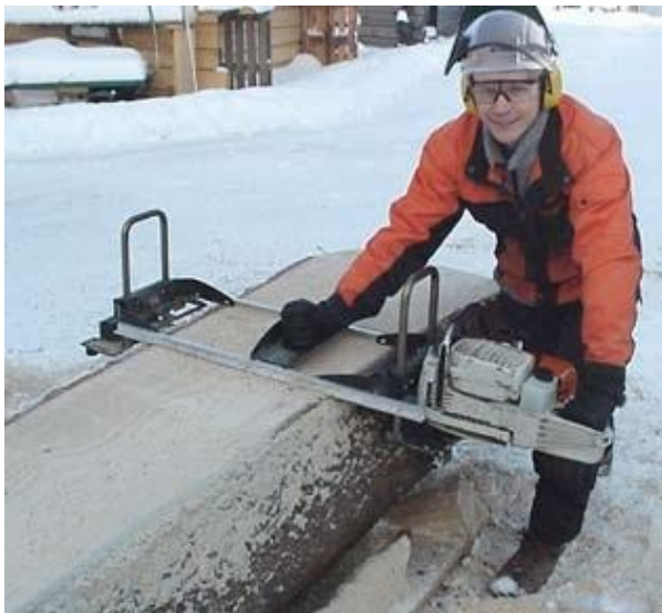
LSG без направляющих рельс. Плоская поверхность бревна направляет пропил.
